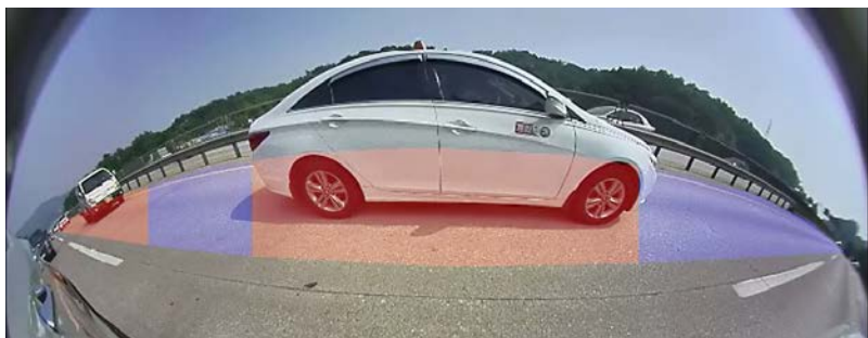
サイドカメラによる死角スポットの検出
